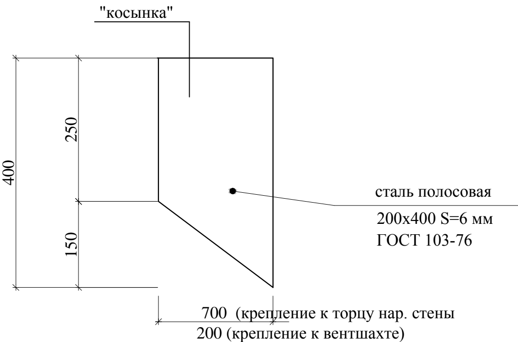
деталь крепления (заложить в кладку)
