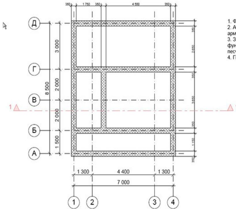
1. Фундамент ленточный монолитный
