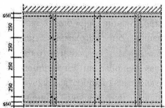
максимальный шаг стоек не более 600мм, расположение стыков ГСП противоположных сторон относительно друг другу (минимум 150 мм).
